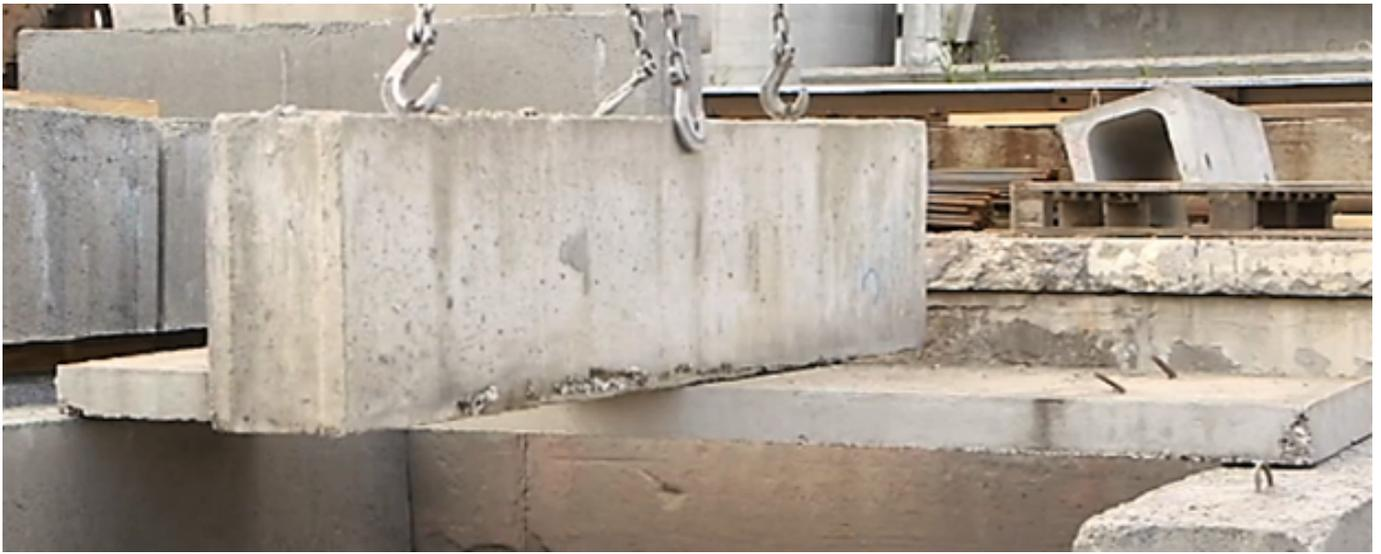
***Рисунок 3. Проверка прочности бетонной плиты***
