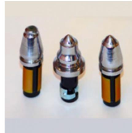
**Рисунок 3. Шнеко-фрезерный буровой инструмент**      **Рисунок 4. Режущий инструмент горных машин**
