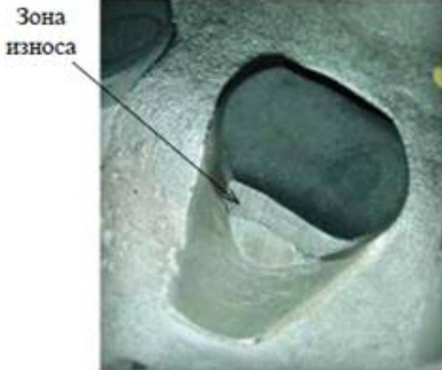
**Рисунок 1. Зона износа фиксированного резца PDC**
