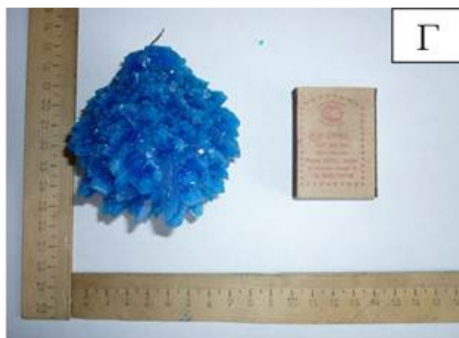
Рисунок 2. Форма и размеры кристаллов \text{CuSO}_4 \cdot 5\text{H}_2\text{O} :
