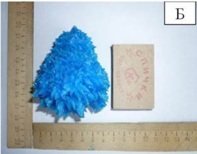
Рисунок 1. Форма и размеры кристаллов \text{CuSO}_4 \cdot 5\text{H}_2\text{O} :
