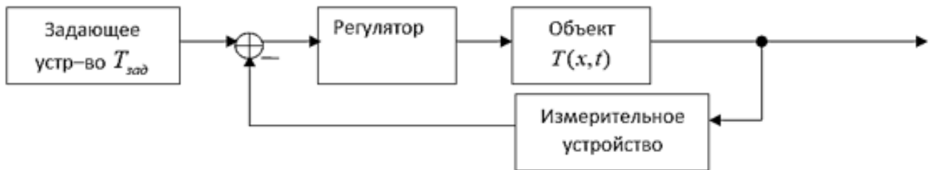
Рисунок 1. Структурная схема замкнутой системы регулирования
