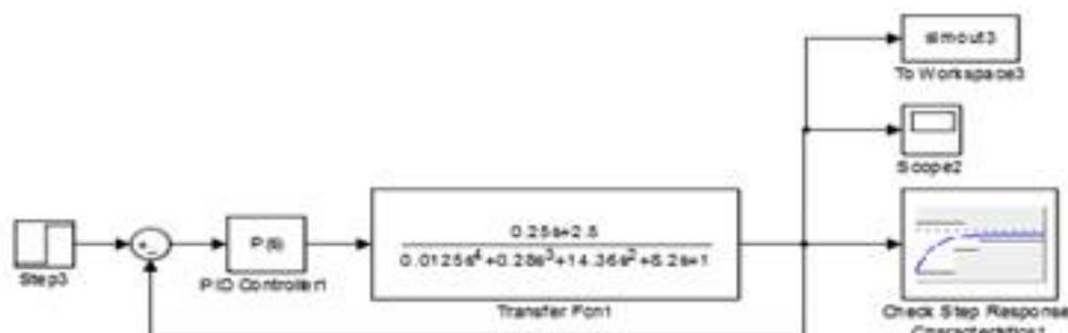
Рисунок 2. Модель системы управления в Simulink
