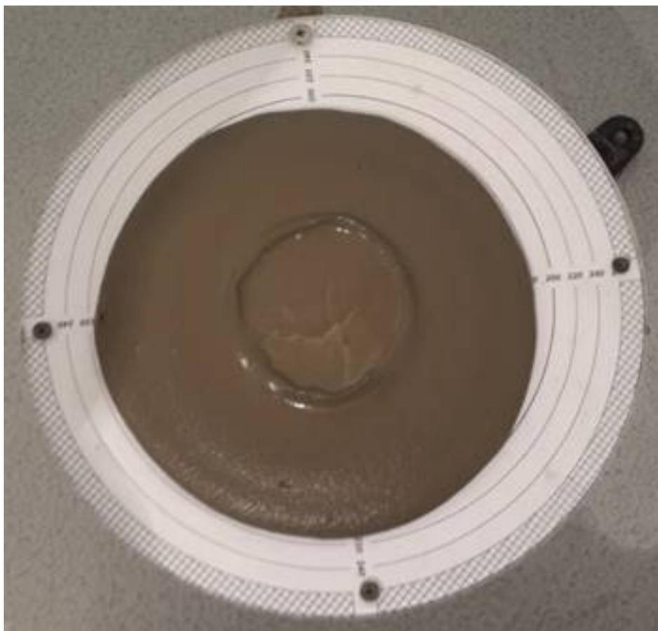
**Рисунок 1. Расплыв конуса цементно-песчаного раствора равен 200 мм**
