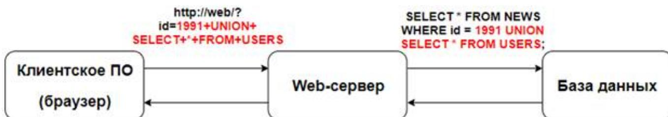
**Рисунок 2. Блок-схема исполнения вредоносного запроса на Web-сайте**
