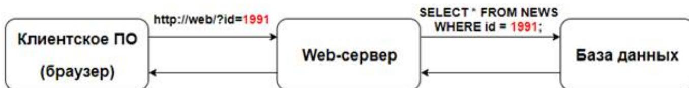
**Рисунок 1. Блок-схема нормальной работы Web-сайта**
