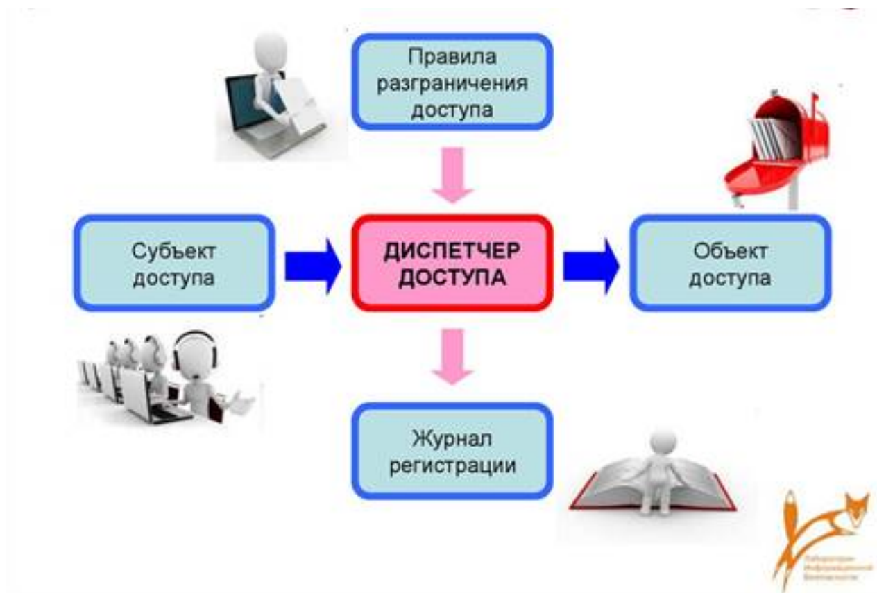
Рис. 1. Представление работы конструкции разделения доступа
