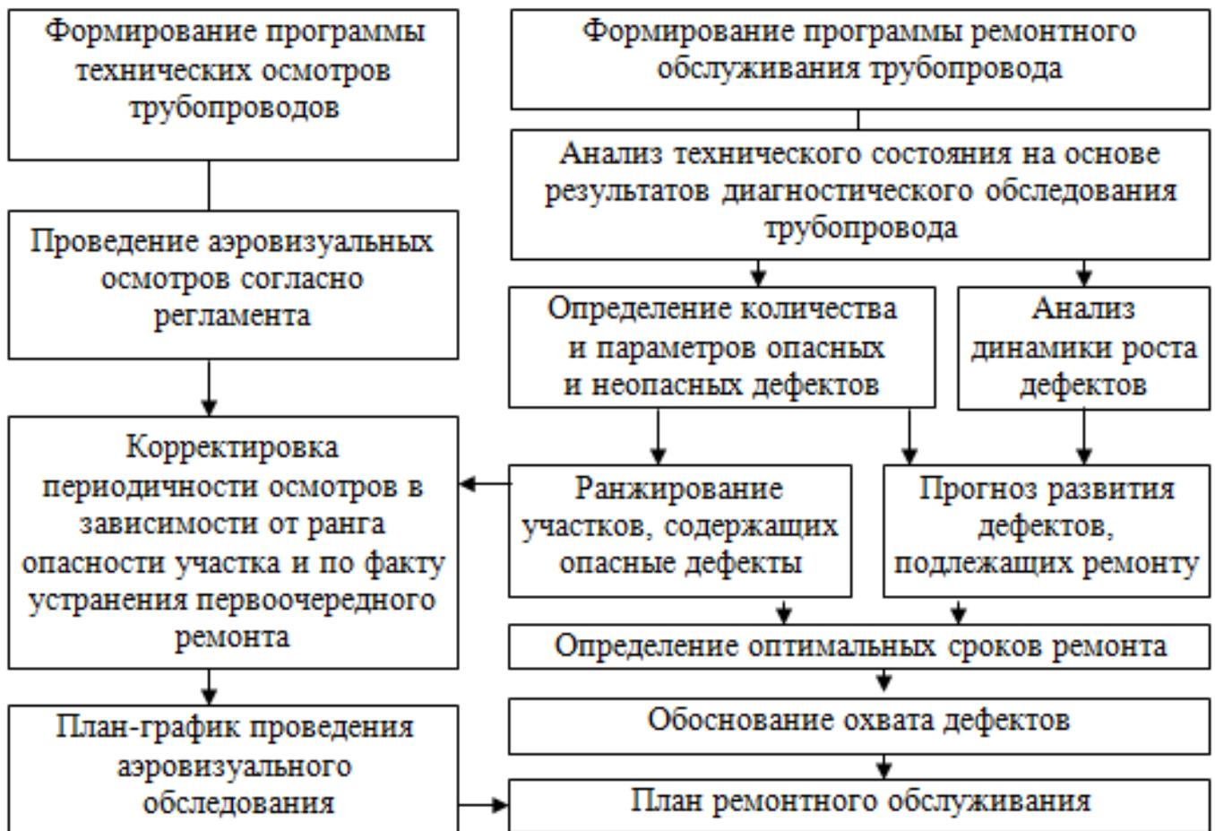
**Рисунок 2. Координация планов технических осмотров и ремонтного обслуживания магистральных трубопроводов [5]**
