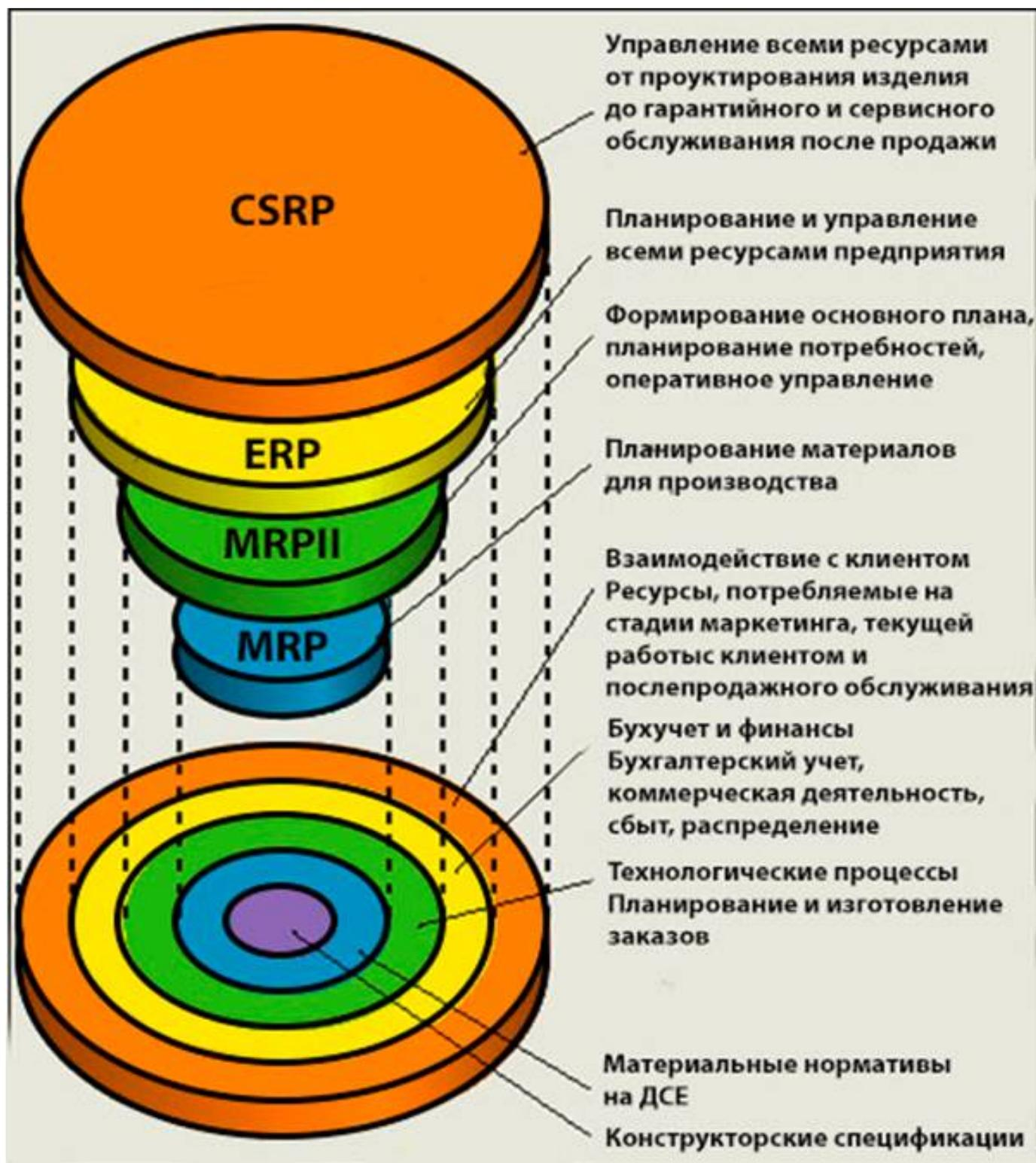
Рисунок 1. Схема эволюционирования методов: MRP, MRP II, ERP, CSRP
