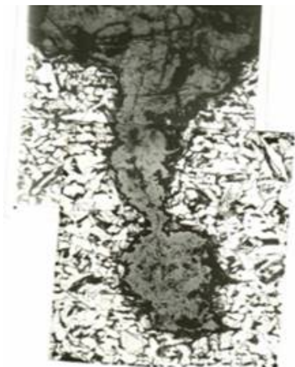
Рисунок 3. Характер трещин, развивающихся с внутренней поверхности нейтральной зоны гига
