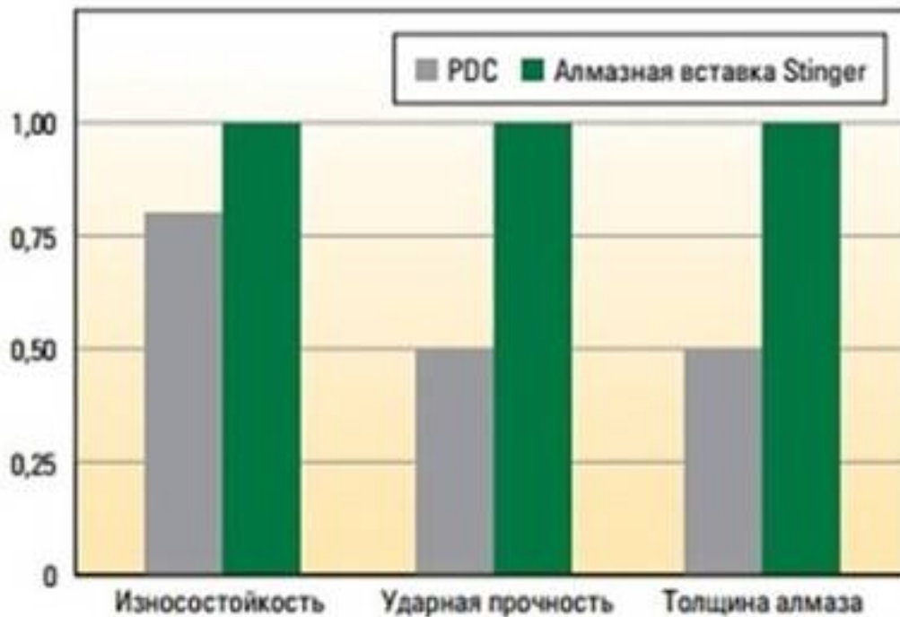
Рисунок. 2 Сравнительная характеристика долота PDC и долота со вставками Stinger
