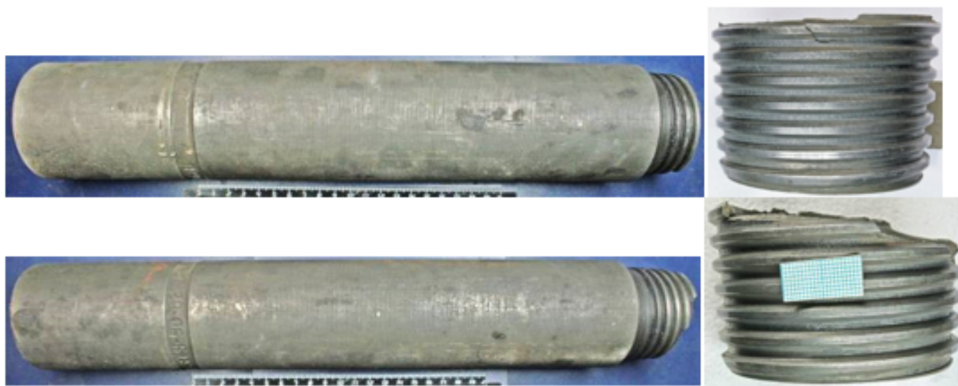
Рисунок 1. Разрушение резьбовых соединений переходников
