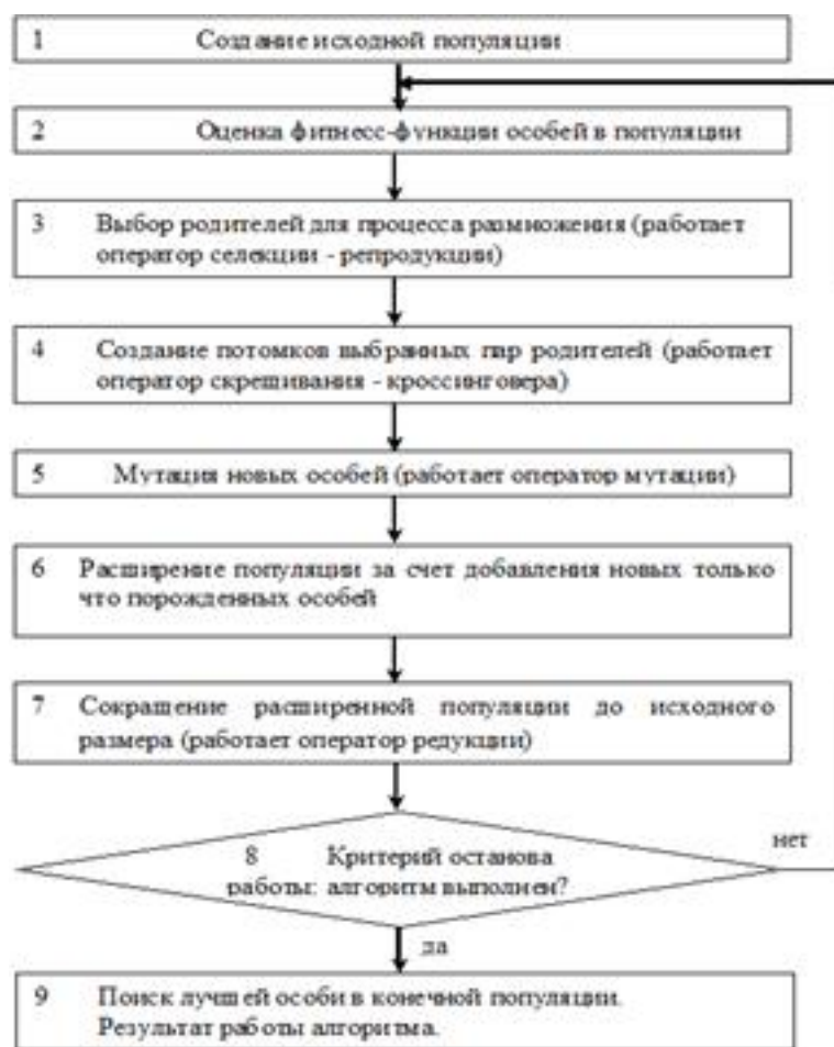
Рисунок 4. Блок-схема простого генетического алгоритма
