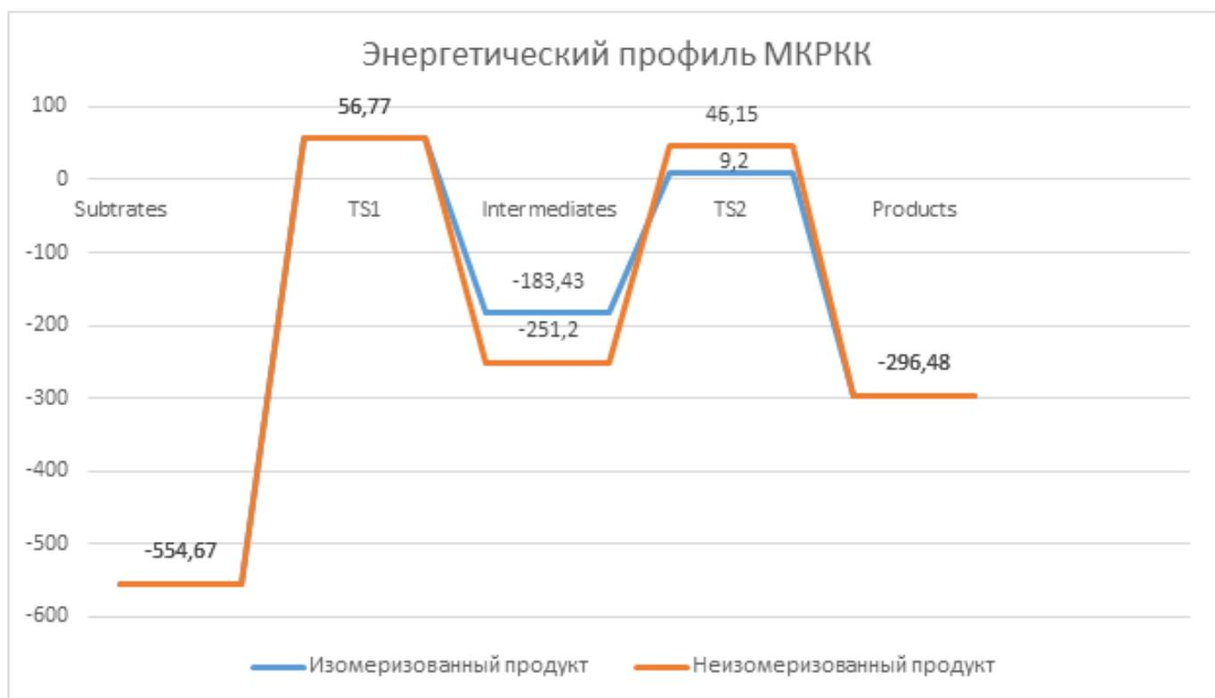
**Рисунок 3. Энергетический профиль МКРКК**
