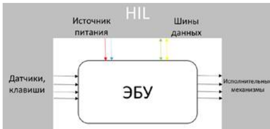
Рисунок 1. Типовая принципиальная схема подключения ЭБУ к HIL
