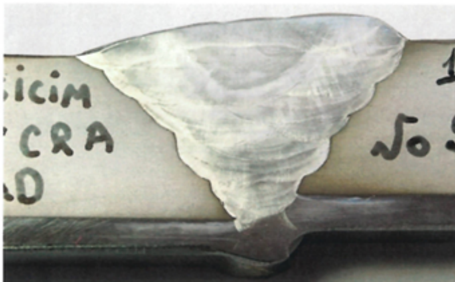
Рисунок 3. Макрошлиф сварного шва плакированной трубы API 5L 415Q и сплава Alloy 625
