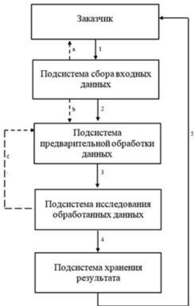
**Рисунок 2. Структурная схема корпоративной системы**
