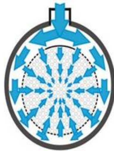
Поперечное сечение – режим обратной промывки
