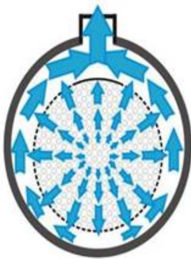
Поперечное сечение – режим фильтрации
