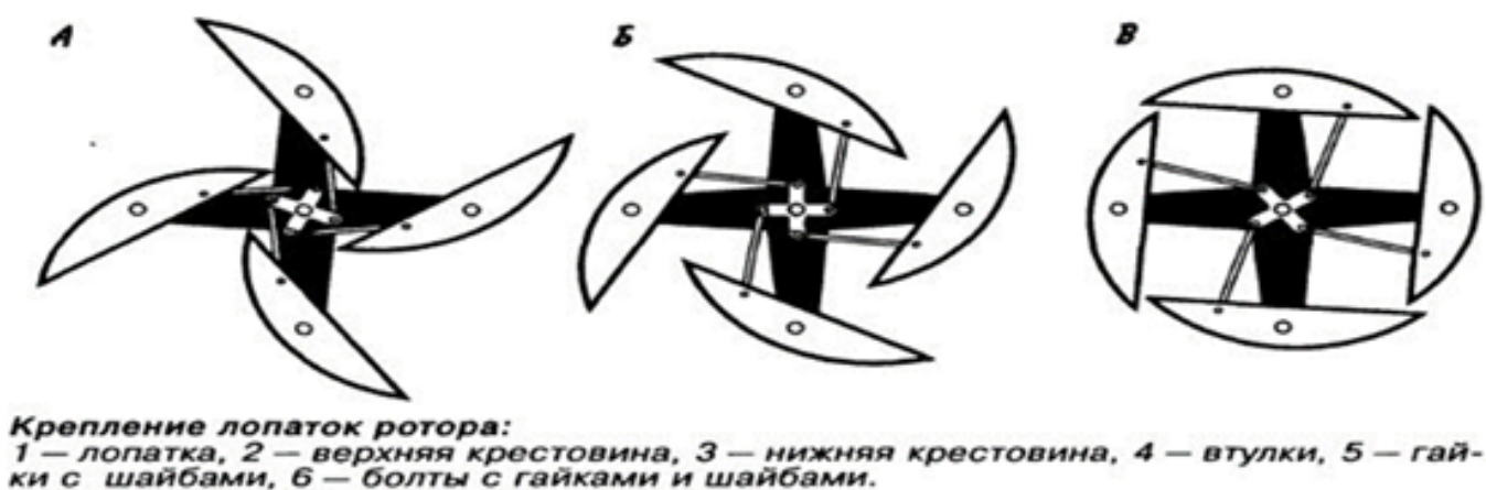
Рис. 1. Крепление лопаток ротора роторных ветрогенераторов
