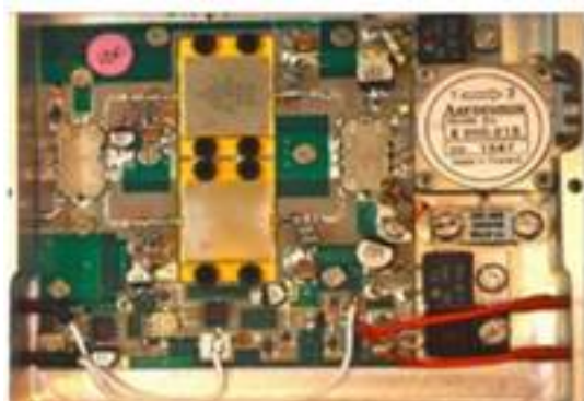
Сурет 1. Күшейткіш модулінің ішкі тізбегінің физикалық картасы
