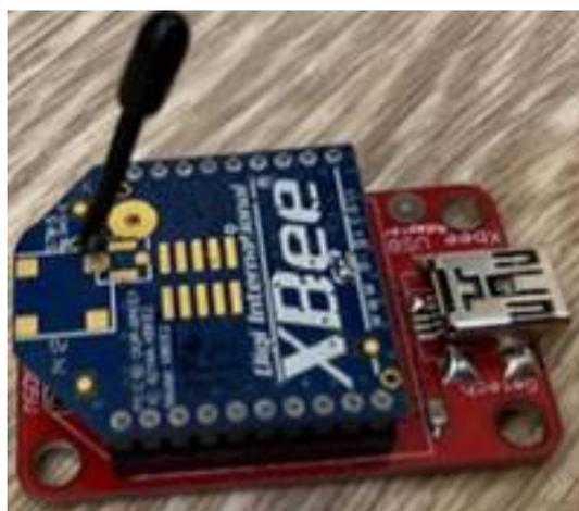
*Рисунок 3. Модуль ZigBee приемной стороны*
