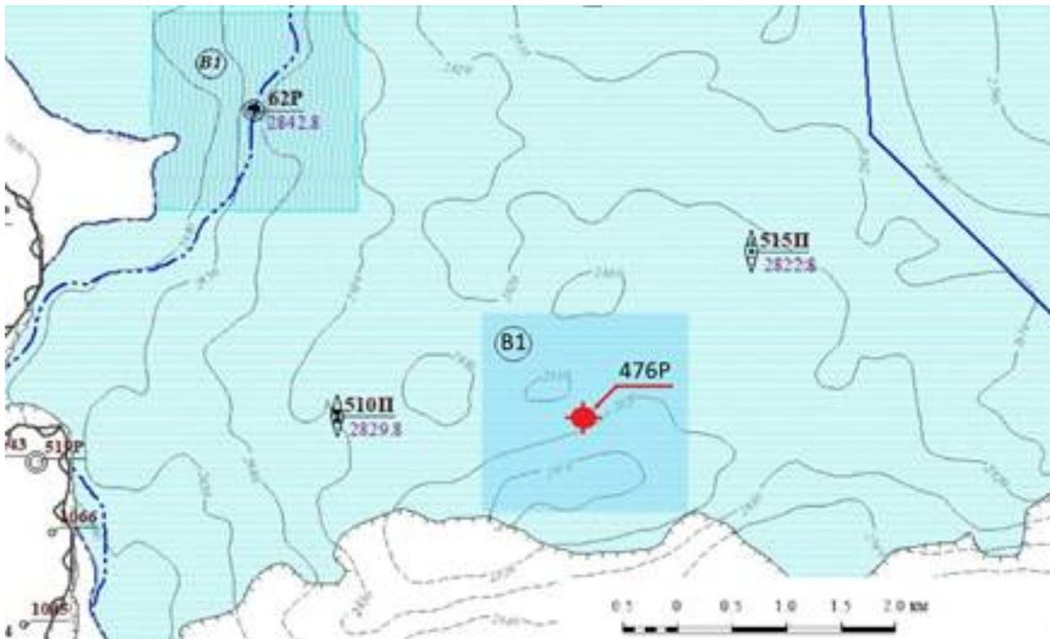
**Рисунок 3. Выкопировка из подсчетного плана по пласту АЧ<sub>6</sub><sup>2</sup> Имилорского месторождения с проектной скважиной 476Р. Условные обозначения см. на рис. 1**
