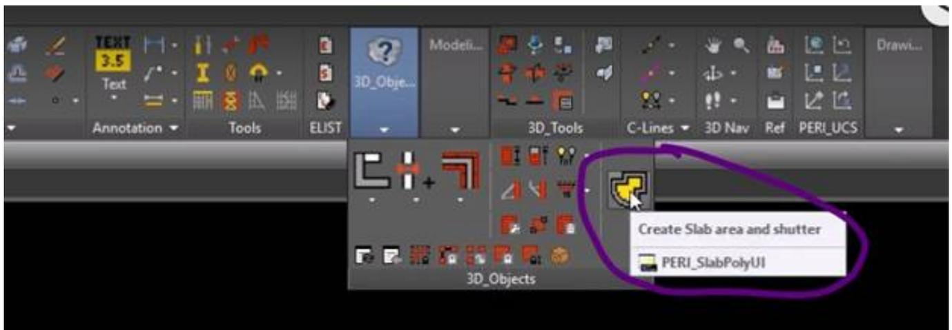
**Рисунок 10. Функция для создания раскладки перекрытий**
