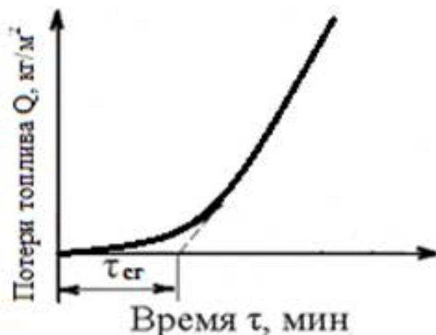
**Рисунок 2.** Общий вид зависимости потерь топлива от времени хранения
