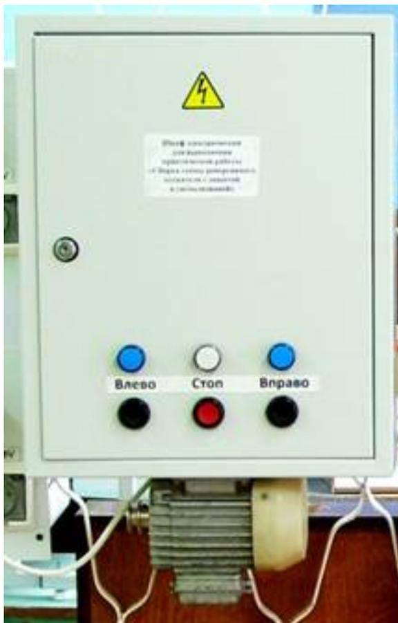
***Рисунок 3. Стенд «Шкаф электрический для сборки схемы реверсивного пускателя с защитой и сигнализацией»***
