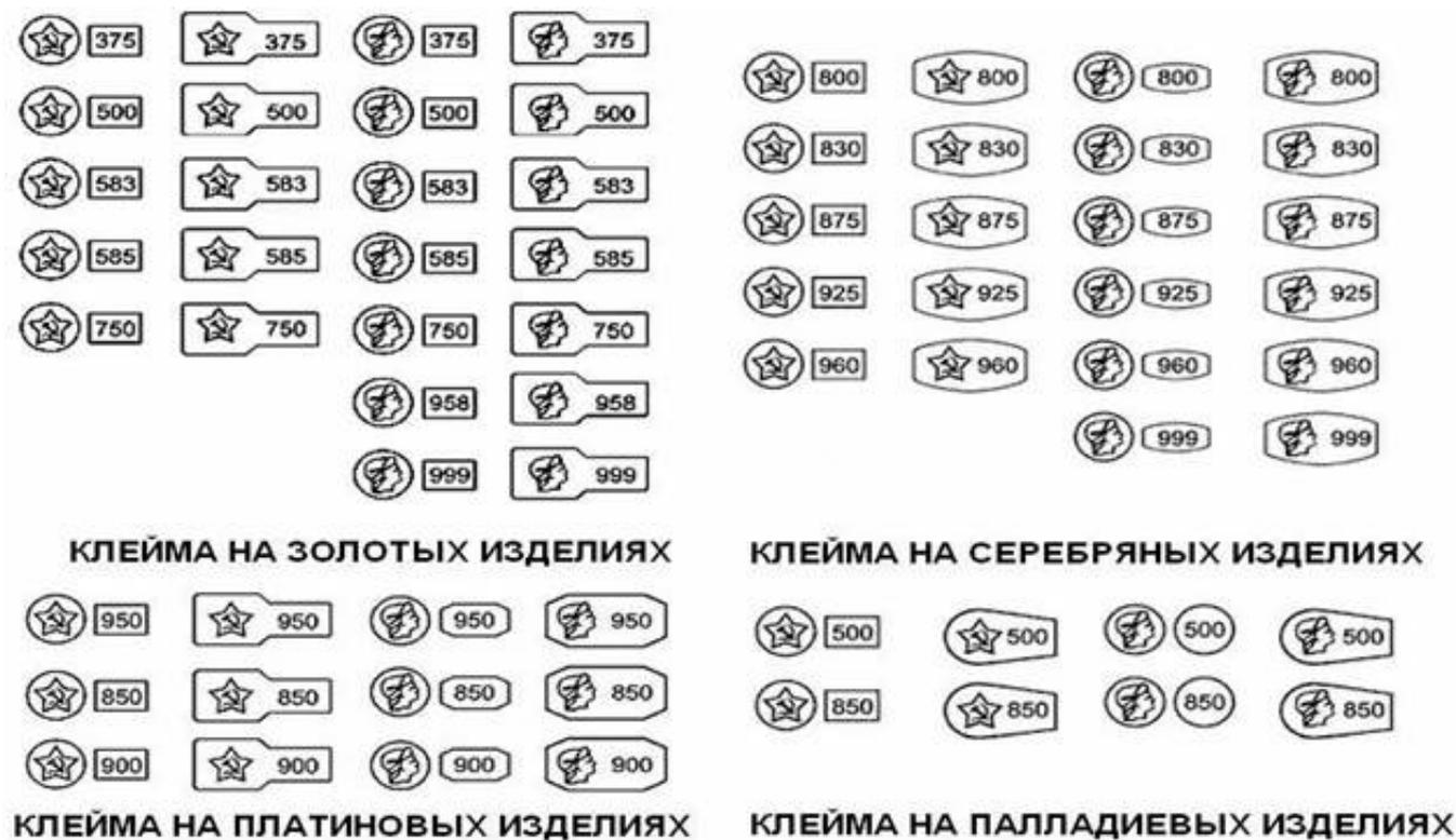
Рисунок 2. Клейма на драгоценных металлах с пробой
