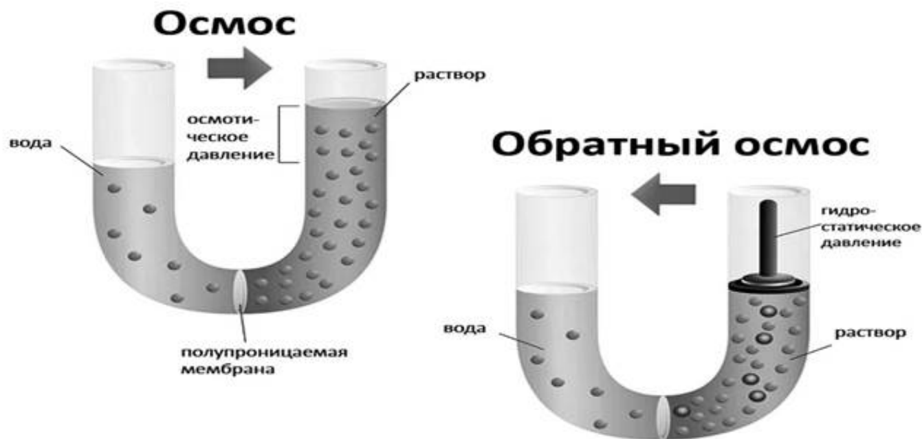
Рисунок 2. Схема прямого и обратного осмоса
