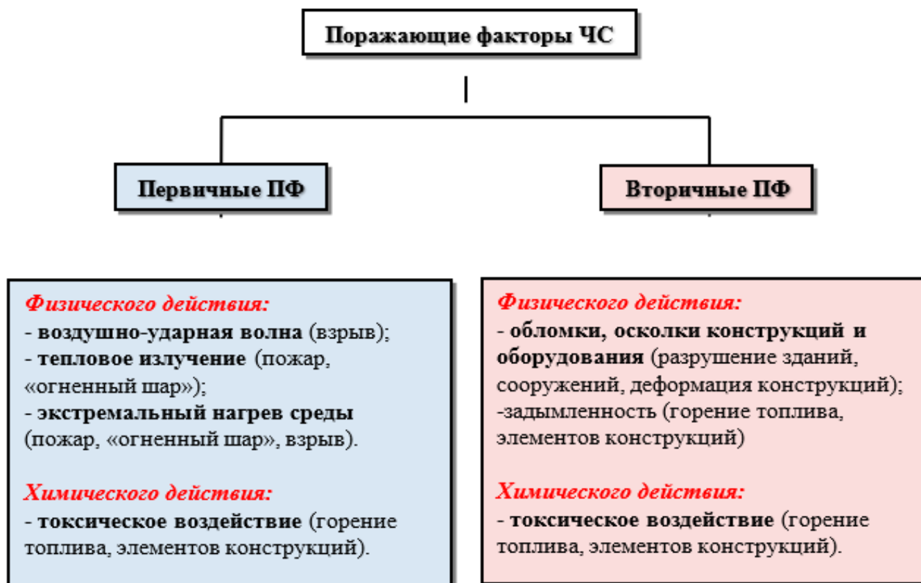
Рисунок 1. Поражающие факторы и их источники при ЧС на АЗС
