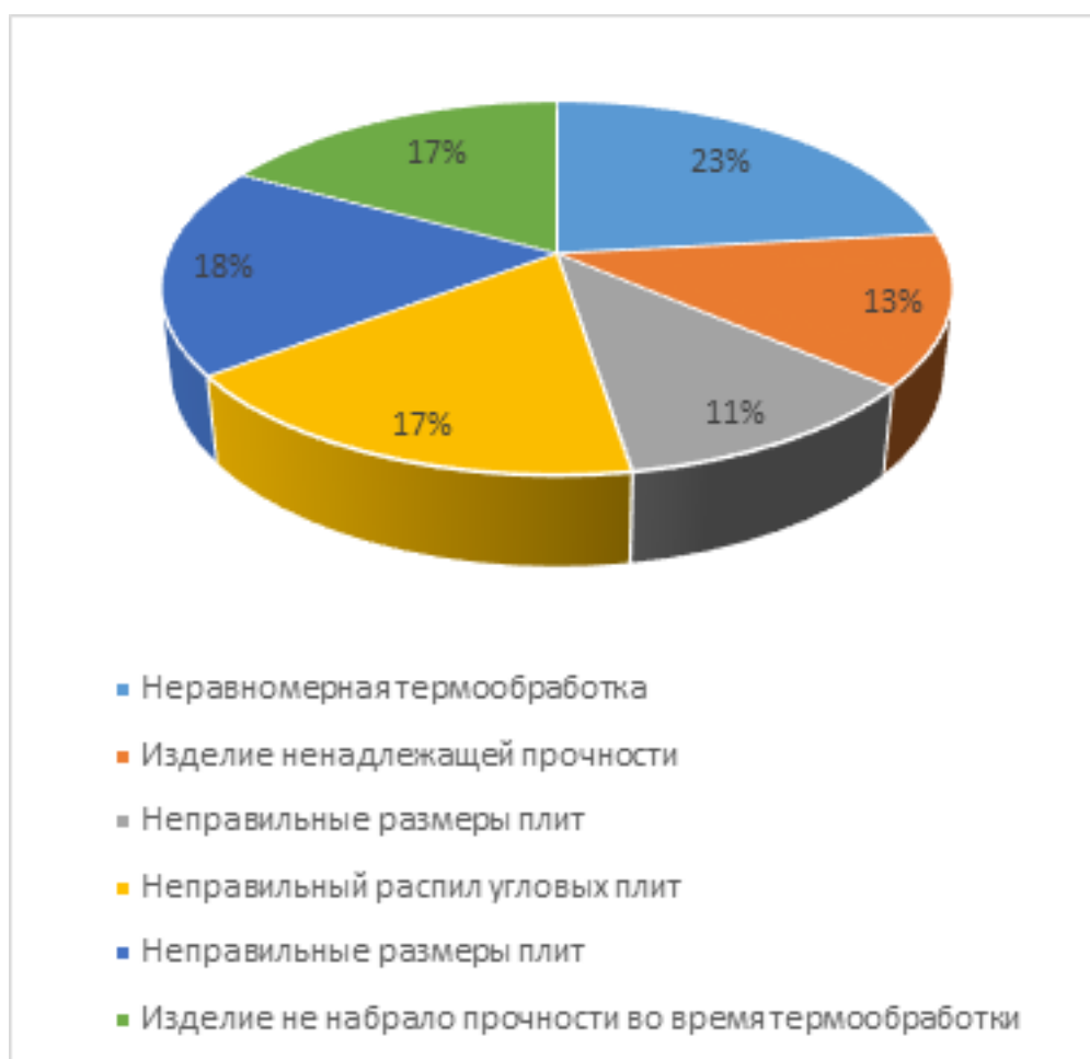
Рисунок 1. Распределение долей отказов по этапам производства
