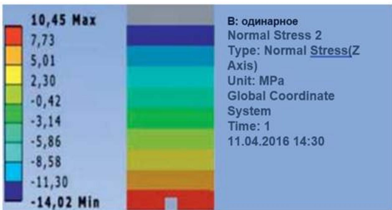
*Рисунок 4. Распределение нормальных напряжений в поперечном сечении балки в середине пролета*
