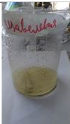
Рисунок 4. Образец № 2. Арматура m=18 г, янтарная кислота
