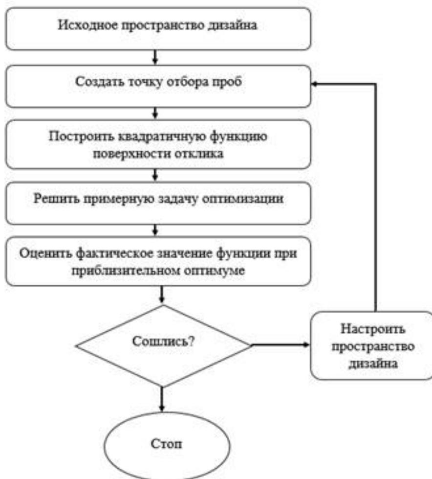
Рисунок 1. Блок-схема процесса оптимизации PQRSM
