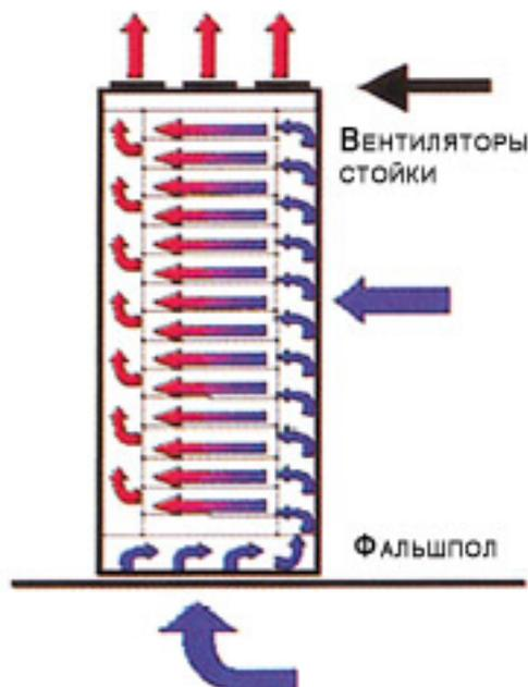
**Рисунок 2. Схема вентилируемой стойки**
