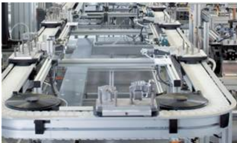
Рисунок 3. Конвейерное решение для сборочных производств и связующих машин
