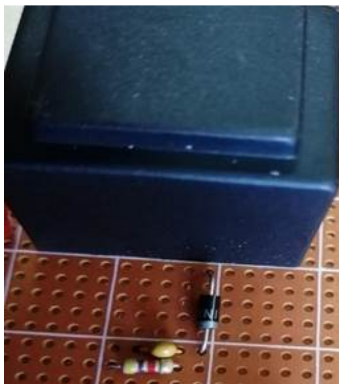
Рисунок 2. «Готовая схема включения выпрямителя»
