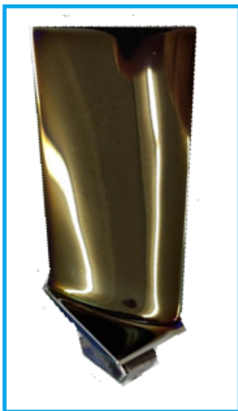
Рисунок 5. Лопатка ГТД после обработки методом сухого электрополирования с последующей ионной имплантацией.
