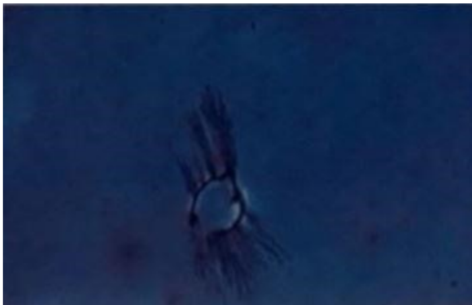
Рисунок 1. Водный триинг, развивающийся от подковообразного загрязняющего включения
