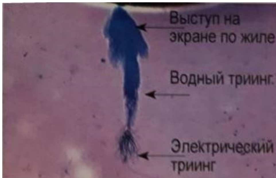
Рисунок 2. Электрический триинг, растущий от водного триинга, примыкающего к экрану по жиле
