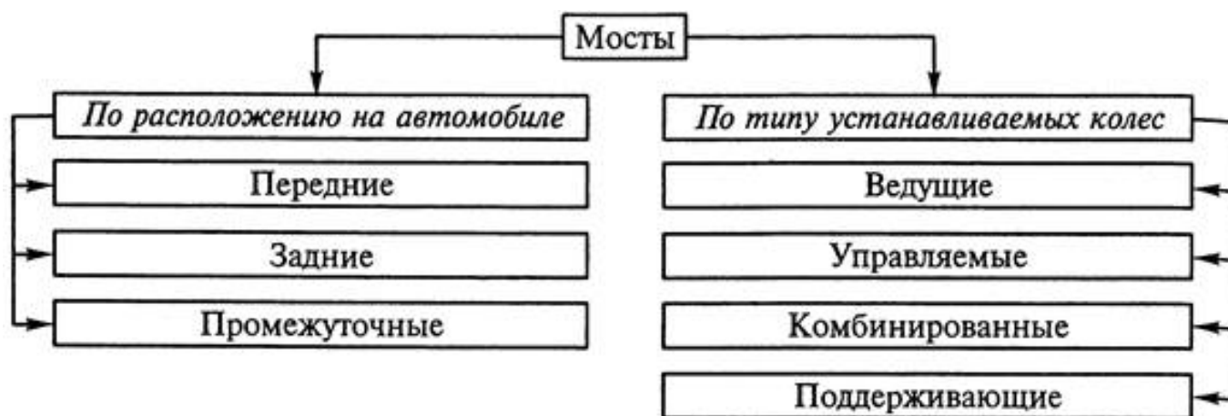
Рисунок 1.1. Классификация мостов автомобиля
