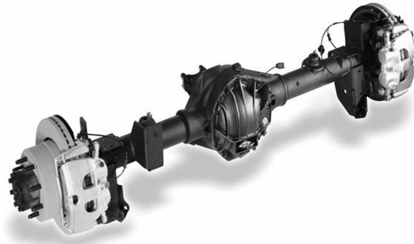
Рисунок 1.4. Неразъёмный штамповано-сварной ведущий мост
