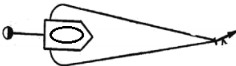
Рисунок 3. Параллельное соединение насосно-рукавной системы
